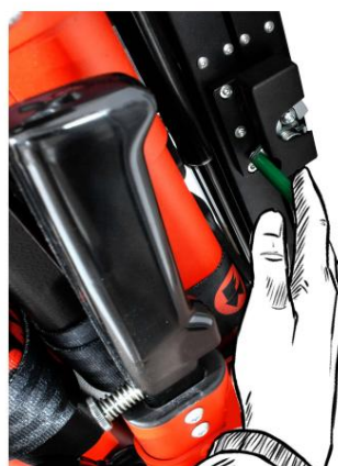
Lossa säkerhetsbältet och dra ut FAST-LIFT X mot dig medan du låser upp den gröna spaken som sitter på sidan av FAST-LIFT X (Figur 2).
