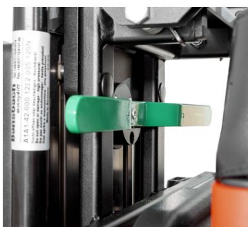
Dra den gröna spaken mot dig och flytta FAST-LIFT X nedåt.
