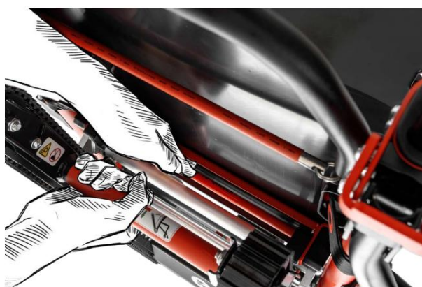
Lossa spåret från tryck-för-stängning-spärrarna
