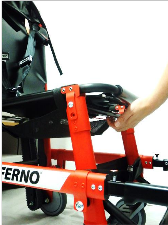
Vedä punainen kaapeli istuimen alla ulospäin
