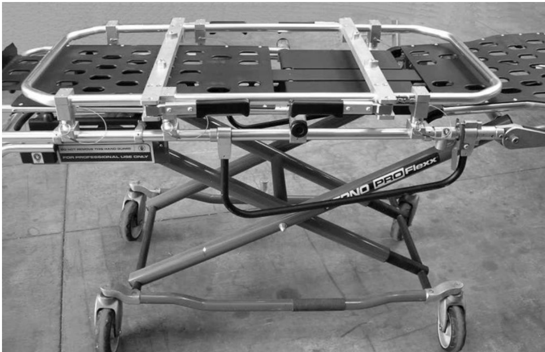
Bild 15: Installation av ITC-HL-ram på Ferno 35P Proflexx
